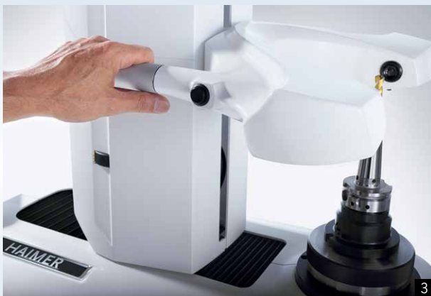
1: Kamerasystem zum Messen der Drehmitte/Camera system for setting the centre of rotation 2: Taktiles Messen der Drehmitte/Tactile measurement of the centre of rotation 3: Release-by-Touch Funktion, einfaches Verfahren ohne Knopf- oder Tastenbedienung/ Release-by-touch function, easy to operate without buttons 4: Komfort-Systemschrank mit 3 Auszügen, Türe und innen liegender Ölwanne. Zusätzlich drei Wartungsöffnungen (allseitig)/ Useful system cabinet with 3 drawers, 1 door and internal oil tray. Plus 3 maintenance openings (on all sides) 5: Folientastatur und µm-genaue Feinverstellung/Keypad and µm-precise adjustment 6: 150° schwenkbare Adapterablage/150° swivelling adapter storage 7+8: Messen nach Rachenlehrenprinzip bis Ø 100 mm/Measuring based on the snap gauge principle for diameters up to 100 mm
